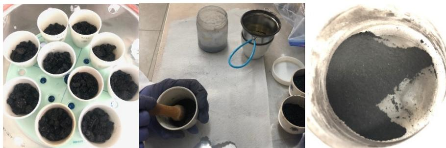
Figura 2. Elaboración de Biocarbón: biomasa pirolisada, molienda, tamizaje y producto final.
