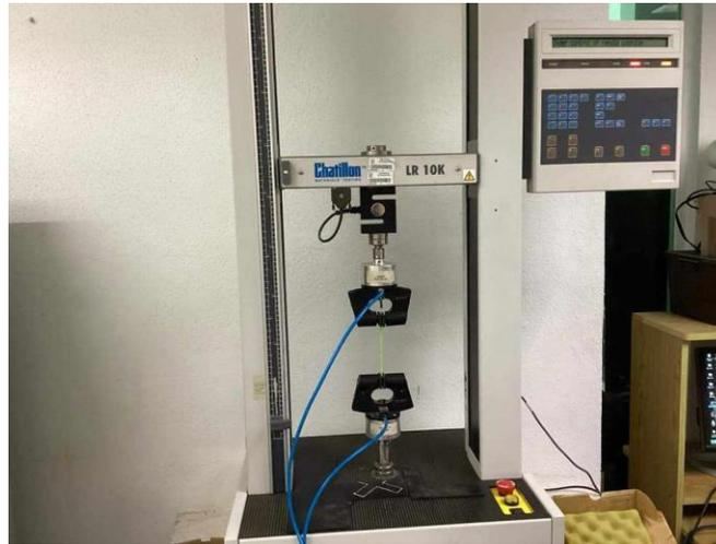
Figura 6. Prueba de compresión a 5mm/s con una carga límite de de 2500 N.
