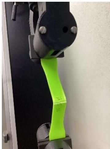
Figura 7. Fractura de probeta de 2.5 mm de espesor al 75% de relleno de impresión.
