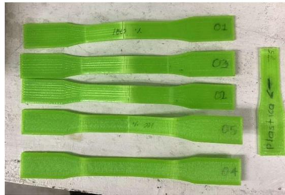
Figura 8. Plasticidad en probetas con las mismas dimensiones: espesor 2.5mm y relleno 100%.
