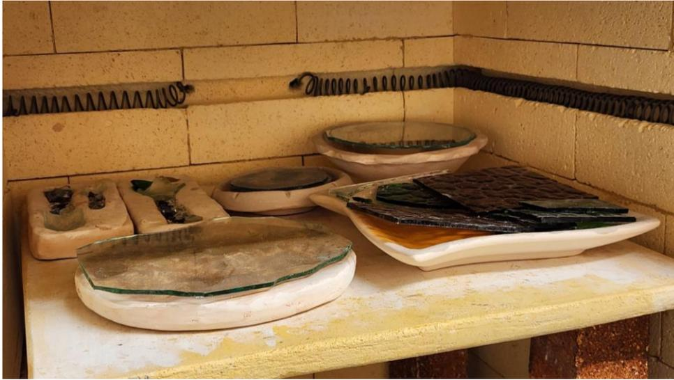
Figura 11. Práctica de termoformado sobre moldes de cerámica.
