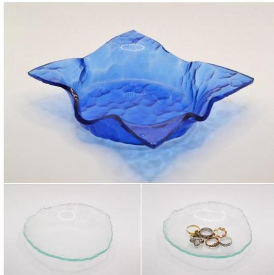
Figura 16. Resultados de termoformado sobre moldes de cerámica.
