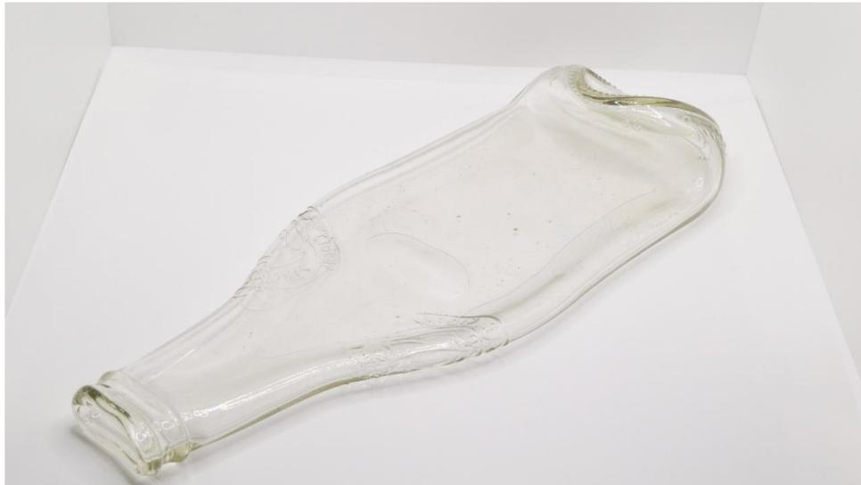
Figura 14. Resultado de botella de vidrio termoformado sobre base plana de cerámica.
