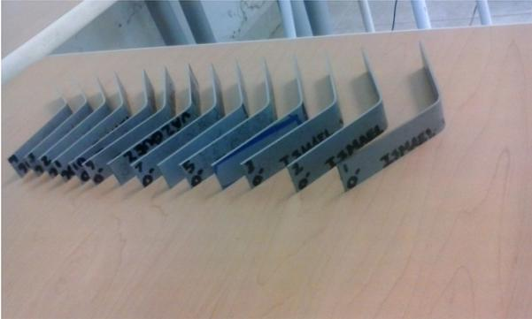
FIGURA 4. Probetas sometidas a flexión pura
