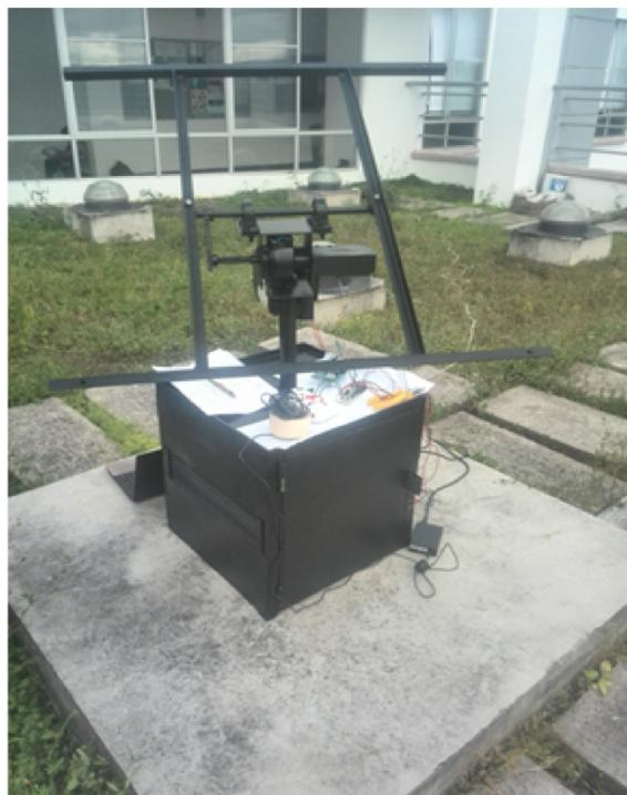
Figura 11. Seguidor Solar ensamblado.
