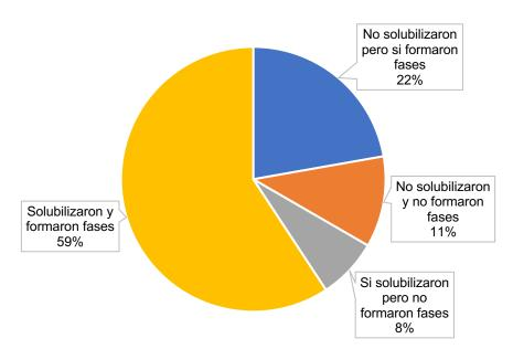
Figura 7. Diagrama de distribución de los resultados de las 30 mezclas para formar ATPS a partir de PEG/Salmuera diluida, adicionando sulfato de sodio al medio.
