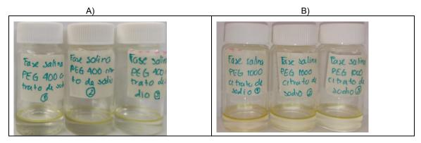
$Figura~4.~A)~Fase~salina~del~sistema~con~PEG-400~g\cdot mol^{-1}/citrato~de~sodio.~B)~Fase~salina~del~sistema~con~PEG-1000~g\cdot mol^{-1}/citrato~de~sodio~del~sistema~con~PEG-1000~g\cdot mol^{-1}/citra$
