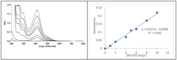
Figura 5. A) Espectros UV de la reacción del complejo Nd(III)/PAR. B) Curva de calibración de Nd(III). Relación metal:ligando; 1:2.2, pH 7.
