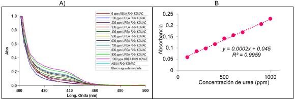
Figura 2. A) Espectros UV de la reacción de urea con reactivo Kovac en función de su concentración en un rango de 100 a 1000 ppm. B) Curva de extracción de urea a distintas concentraciones en un rango de 100 a 1000 ppm.
