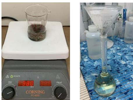
Figura 2. a) Sistema por lote para la adsorción de Cr(VI) sobre residuos de café. b) Solución filtrada después de la adsorción.
