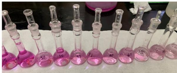
Figura 3. Análisis del contenido de Cr(VI) por espectrofotometría de UV-Visible.
