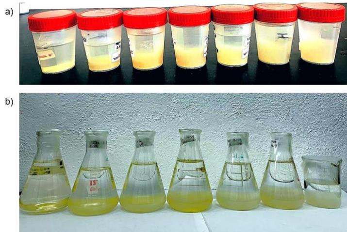
Figura 6. Resultados de las muestras obtenidas entre el tiempo 0 y 90 minutos de operación para el agua de la presa de "Burrone": a) recolección inicial y b) transcurrido el tiempo de sedimentación.
