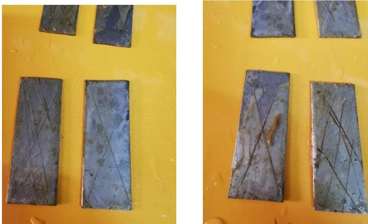
**Imagen 2.** Cortes realizados en las pruebas con el polímero del 2% (izquierda) con los cortes realizados en las pruebas con el polímero del 4%.
