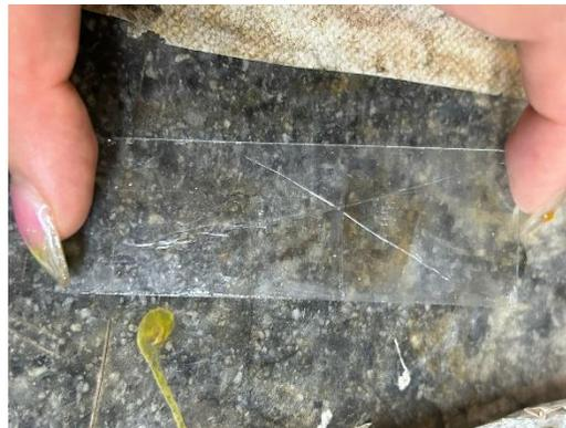
**Imagen 6.** Cortes realizados a lamina de vidrio.
