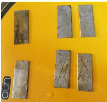
**Imagen 1.** Preparación de las láminas intervenidas para las pruebas de corrosión
