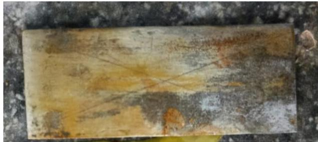
**Imagen 4.** Progresión de la corrosión en la placa control
