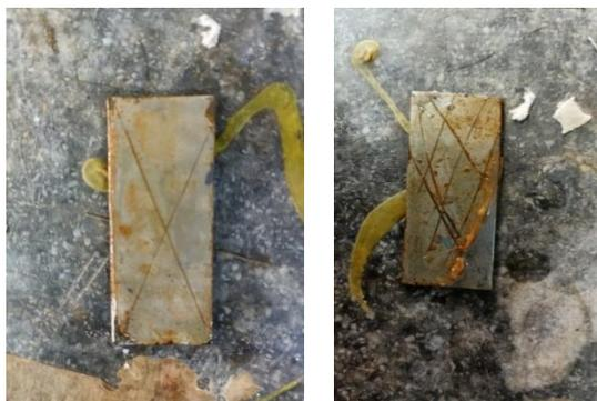
**Imagen 3.** Placas de prueba después del período de 96 horas. Del lado izquierdo se encuentra la del 2% y del lado derecho la del 4%.
