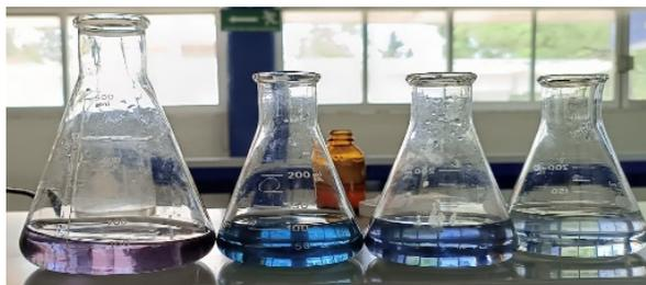
Figura 1. Determinación de la dureza mediante el uso del indicador Negro de Eriocromo T.
