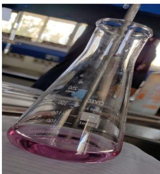
Figura 2. Muestra de agua sometida a prueba de alcalinidad, se observa el viraje del indicador fenolftaleína.
