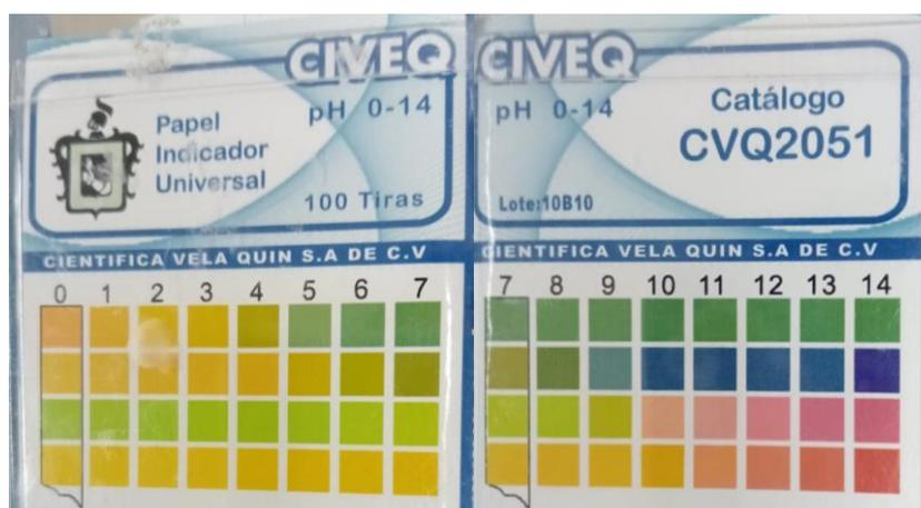
Figura 5 Gama de coloración del papel indicador universal de pH con cuatro indicadores.
