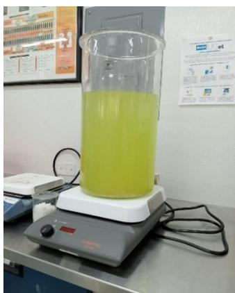
Figura 8 Se repitió el análisis, pero con un volumen de 8 litros. Con los datos obtenidos en las dos muestras A y B se determinó aproximadamente cuantos gramos se requerían de NaOH dejando libre un rango para hacer la adición de pesos pequeños y medidos con la finalidad de no llevar el pH de la solución hasta un pH básico.
