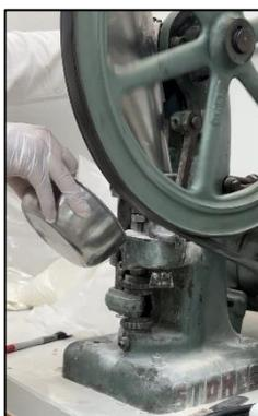
Figura 13 Tableteadora rotativa de un punzón modelo STOKES
