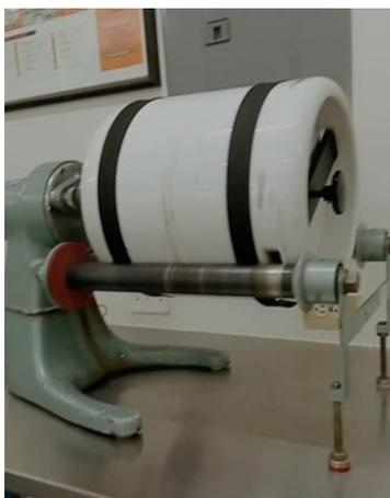
*Figura 11 Molino de bolas en proceso de molienda.*
