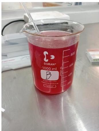
Figura 7. En la experimentación cuando se superó el punto de equilibrio la solución tomó la coloración roja, que nos dio una lectura de pH 12. Agregando 17.5 g y 18.3 g de NaOH en las muestras A y B.
