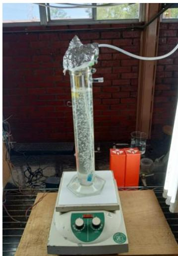
Figura 8. Fotobiorreactor inoculado con *Chlorella* sp. en medio MBB modificado.
