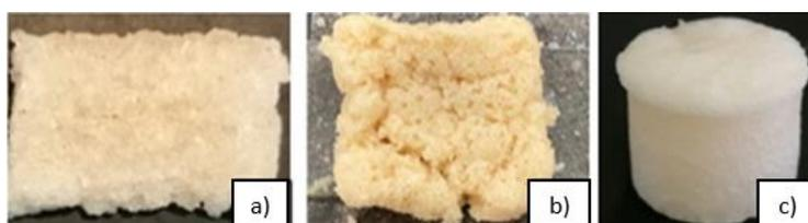
Figura 5. Esponjas sintetizadas por Hy, RV y template: a) 1:2 azúcar, (b) 1:2:4 azúcar : sal (50:50), (c) AMHy relación estequiométrica equivalente emulsión.
