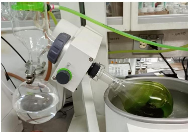
Figura 8. Evaporación de las fracciones mediante el uso de un rotavapor.
