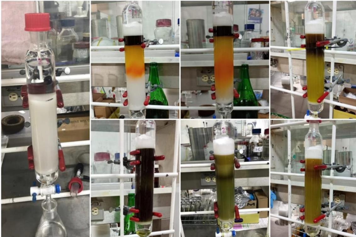
Figura 6. Proceso de elución de la columna cromatográfica con diferentes sistemas de fase móvil, preparada con una mezcla de disolventes hexano: acetato de etilo
