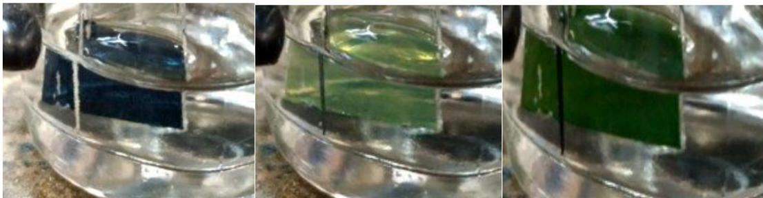
Figura 10. Imágenes de los colores de los diferentes estados de oxidación de la PANI
