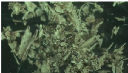
Figura 4. Fibras lignocelulósicas en microscopia estereoscópica. Fuente: Autor
