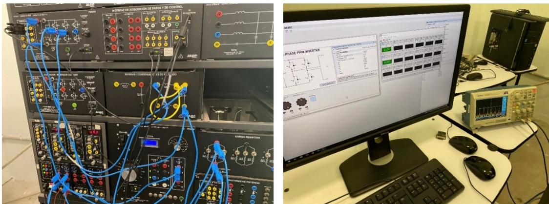
Figura 9. (Izquierda) Sistema ECS-carga no-lineal interconectado. (Derecha). Monitore de software para control del inversor y adquisición de parámetros medidos.
