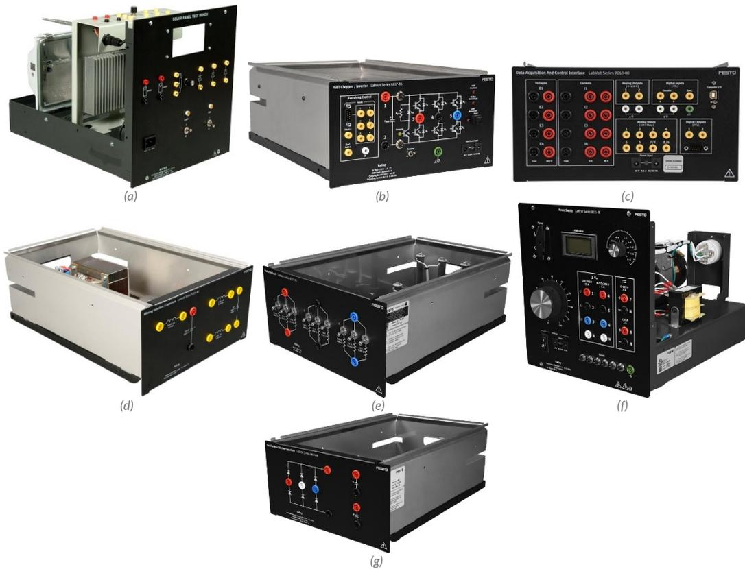
Figura 8. (a) Panel fotovoltaico de Silicio monocristalino. (b) Inversor de IGBTs. (c) Interfaz de control y adquisición de datos. (d) Capacitores/Inductores para filtrado. (e) Cargas resistivas. (f) Fuente trifásica de CA/CD variable. (g) Rectificador de diodos.
