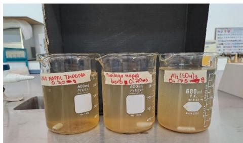
Figura 5. Muestras de agua tratada con mucílago de *Opuntia robusta*, mucílago de *Opuntia ficus-indica* y sulfato de aluminio tras ser sometidas a agitación.
