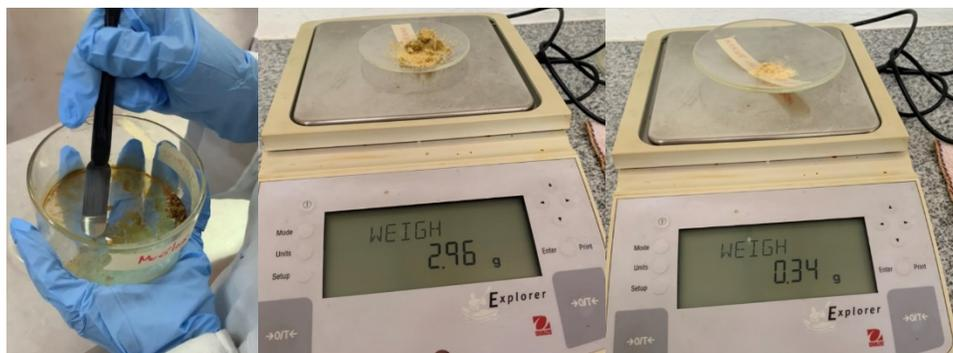
Figura 4. Izquierda a derecha. Raspado del mucílago. Determinación de gramos de mucílago obtenidos.
