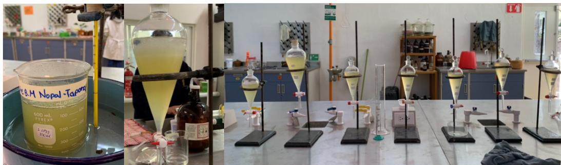
Figura 3. Izquierda a derecha. Mucilago a baño María. Insolubilización de polímeros. Mucilago con etanol reposando.
