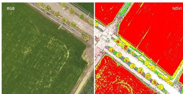
Figura 9. Comparación entre sensores RGB y NDVI [10]
