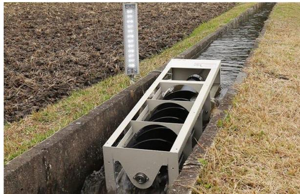
Figura 1. Generador eléctrico a partir de energía hidráulica. Fuente: Eco Inventos Green technology
