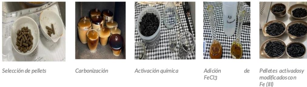
Figura 2. Etapas del proceso de activación y modificación del material adsorbente.
