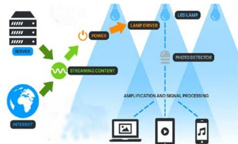
Figura 2: Transmisión de datos por medio de un VLC
