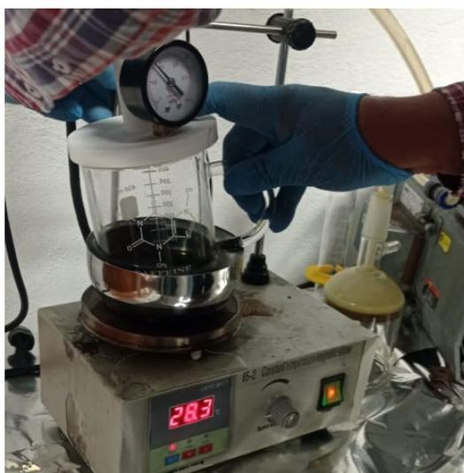
Fig. 3. Montaje experimental para la extracción del aceite vegetal.
