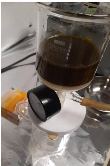
*Fig. 1.* Filtración del extracto a 20 mmHg de vacío.
