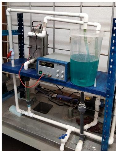
*Ilustración 6. Reactor electroquímico tipo filtro prensa.*
