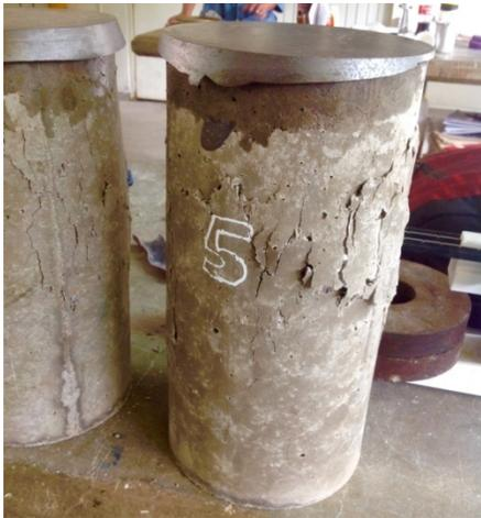
IMAGEN 1: Espécimen de CHL después de la prueba de resistencia a compresión simple.
