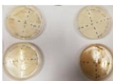
**Figura 10** Medio YPG adicionado con 500 ppm de  $Mn^{+2}$
