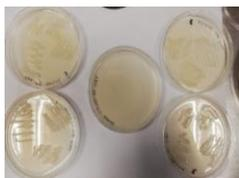
**Figura 12** Medio YPG adicionado con 2000 ppm de  $Mn^{+2}$
