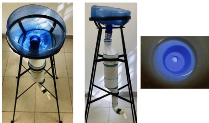
FIGURA 1: Captador individual de agua de lluvia.
