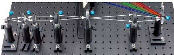
IMAGEN 2: Espectrómetro de rejilla, trayectoria del haz.
