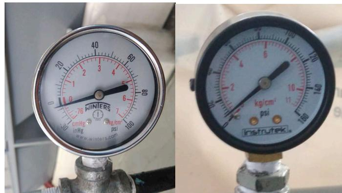
IMAGEN 3 a) Vacuómetro marcando vacío, b) Manómetro elevando presión.
