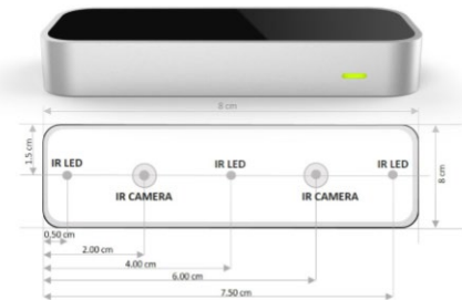
IMAGEN 1: Dimensión física y componentes básicos que conforman el controlador Leap Motion.
