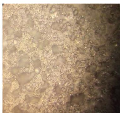
**a)** Imagen a 500x del sustrato de baquelita con la película de CuO ya depositada
