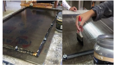
IMAGEN 4: Habilitado y lubricado de moldes para paneles.
