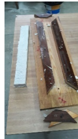
IMAGEN 13: Desmoldado de probetas.
