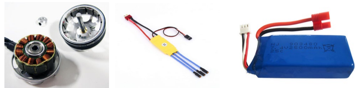
IMAGEN 3: Motor sin escobillas, ESC y batería recargable
