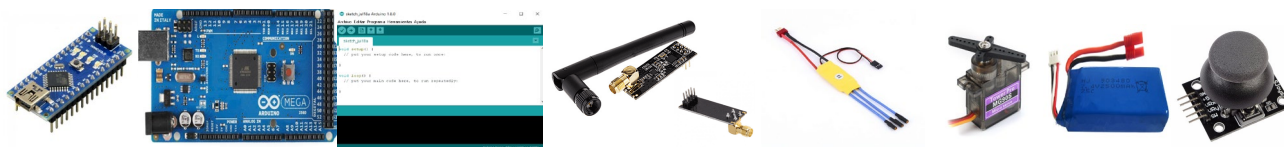
IMAGEN 4: 1. Arduino Nano /2. Arduino Mega /3. IDE /4. NRF24L01 /5. ESC /6. Servomotor /7. Batería LiPo /8. Joystick
