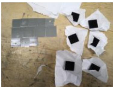
**IMAGEN 3:** Piezas de los veto detectores. Todas las piezas metálicas están pulidas a espejo. El plástico centellador se trata con cuidado para evitar ensuciarlo.
