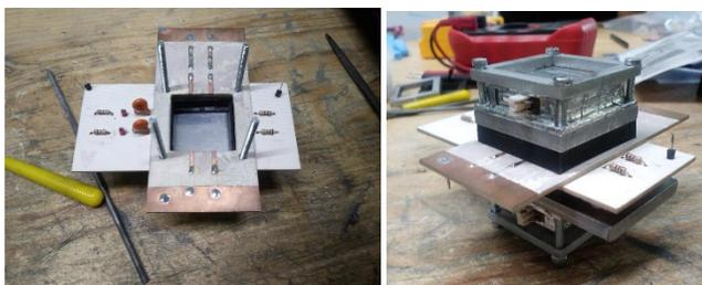
IMAGEN 11: Cámara de ionización de 4 canales con veto detectores armada
