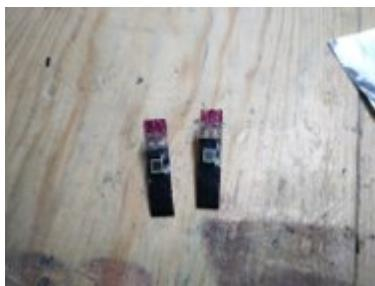
**IMAGEN 4:** Tarjetas con los fotodiodos Hamamatsu S12572-100P.
