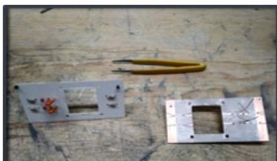
**IMAGEN 8:** Tarjeta de ionización. Componentes eléctricos acomodados y soldados.
