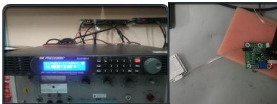
**IMAGEN 6:** Fuente de alto voltaje BK Precision KLN10014 y detector conectado a la placa desarrollada en el laboratorio.
