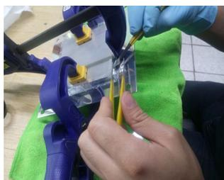
**IMAGEN 5:** Se usa la cinta de aluminio para soldar las piezas.
