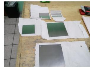
**IMAGEN 3:** Piezas de aluminio con la cara interior pulida a espejo.
