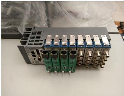
**IMAGEN 8: Sistema de adquisición de datos cRIO.**
