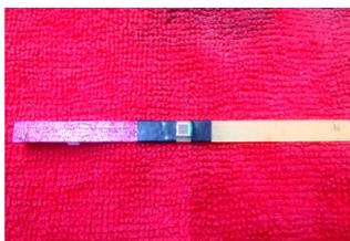
**IMAGEN 4:** Fotodiodo soldado a la tarjeta de conexión, se muestran las pistas aisladas.
