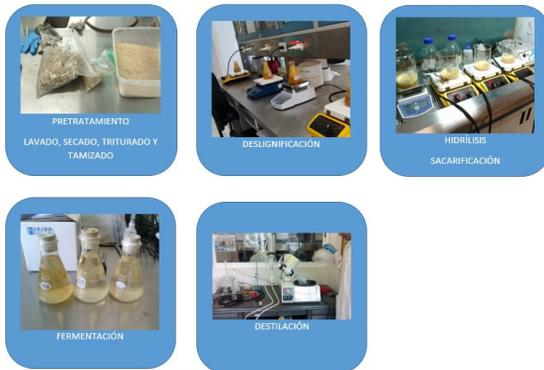
Figura 1: Esquema general para la producción de Bioetanol.
