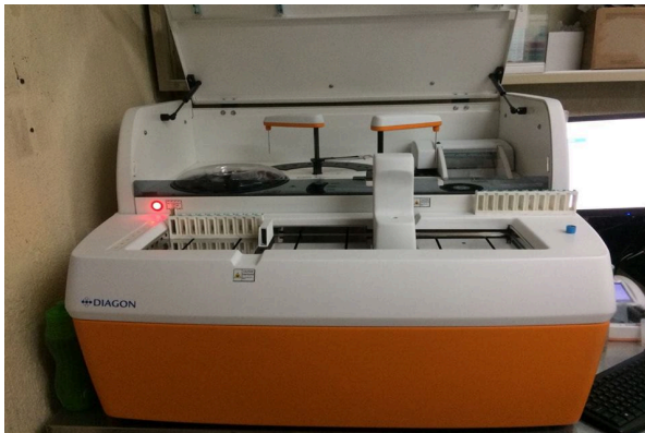
Figura 1. Equipo automatizado en el cual se llevó a cabo el estudio del perfil de coagulación; coagulómetro CoagXL-DIAGON® .
