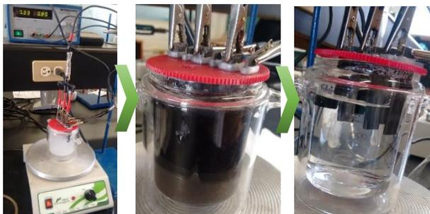
**IMAGEN 1:** (Izquierda a derecha) Montaje de la celda y generación de  $H_2O_2$  *in situ*. Adición de colorante y reactivo Fenton. Finalización de decoloración.
