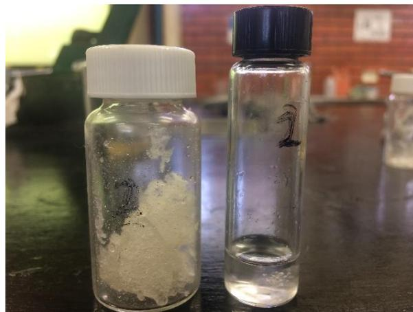
**IMÁGEN 1.** A partir de la izquierda, a) Hidrogel PDMS/ PMHS 10:1, b) Prueba en isopropanol.
