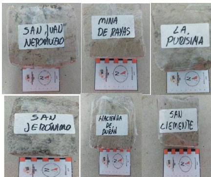
IMAGEN 1. Cubos de las muestras de adobes obtenidas de las 6 Ex haciendas estudiadas
