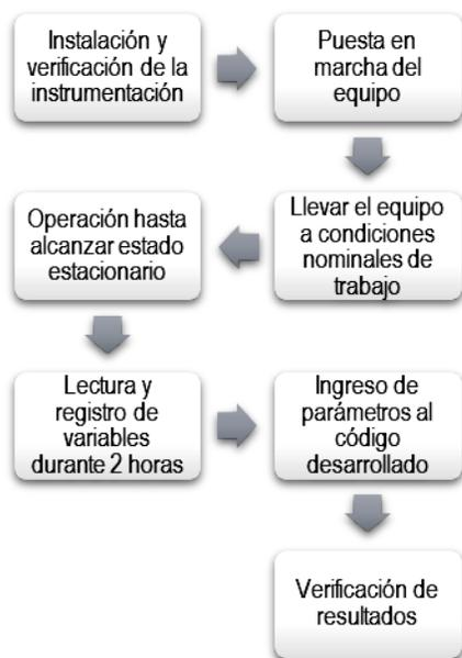
**Imagen 1: Procedimiento para la determinación de la eficiencia energética**
