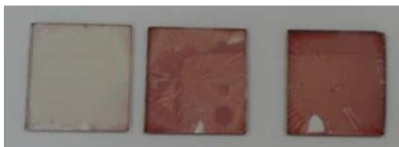
**IMAGEN 3:** Películas delgadas realizadas por técnica de spin-coating. 5 mg P3HT diluidos en 1 ml CB (Izquierda), 10 mg P3HT diluidos en 1 ml CB (central), 10 mg P3HT, 10 mg PCBM en un mililitro CB (derecha).
