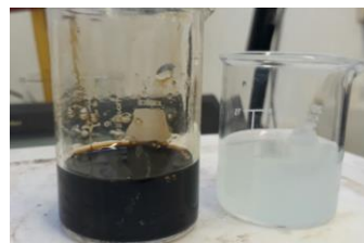
IMAGEN 3: Izquierda fase orgánica (extracto), derecha fase acuosa (refinado).
