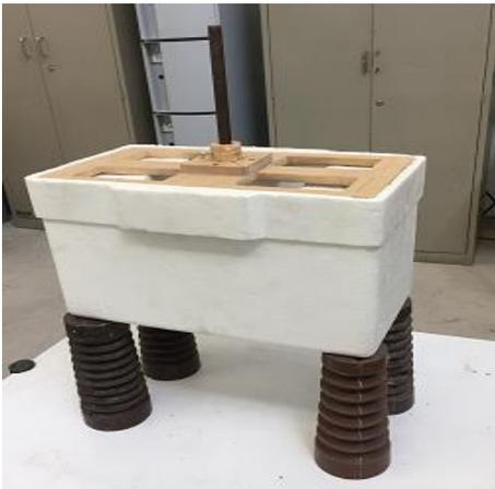
**Figura No. 1: Sistema para pruebas dieléctricas a temperaturas criogénicas (LN<sub>2</sub>)**
