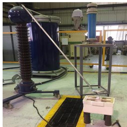
**Figura No. 3: Conexión del equipo de prueba y prototipo para la prueba de tensión alterna para el LN<sub>2</sub> en el LAPEM**
