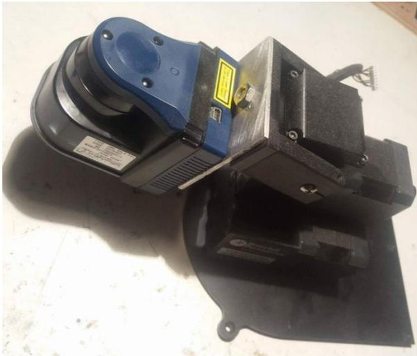
**Figura 4: Sensor láser 2D montado sobre la platina.**
