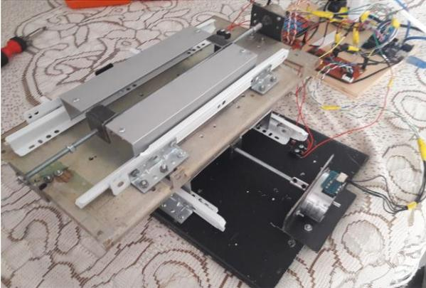
**IMAGEN 12.** Posicionador “xy” y tarjeta electrónica de control.
