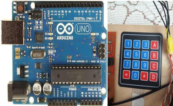
**IMAGEN 10.** Tarjeta de control para los servomotores y teclado matricial.
