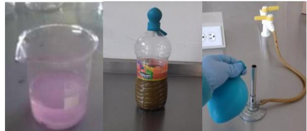
IMAGEN 4: Pruebas para verificar existencia de metano
