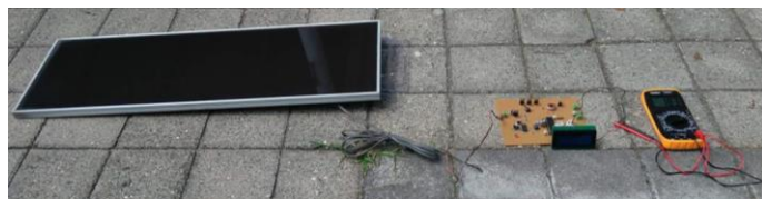
IMAGEN 6: Realización de las mediciones en el segundo panel.
