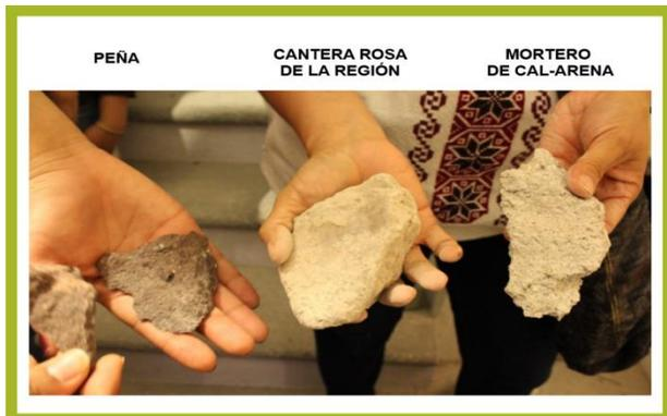
IMAGEN 3: Componentes del Muro, Equipo Verano 2017
