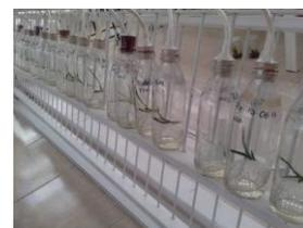
**IMAGEN3: Biorreactores en el soporte de inclinación**
